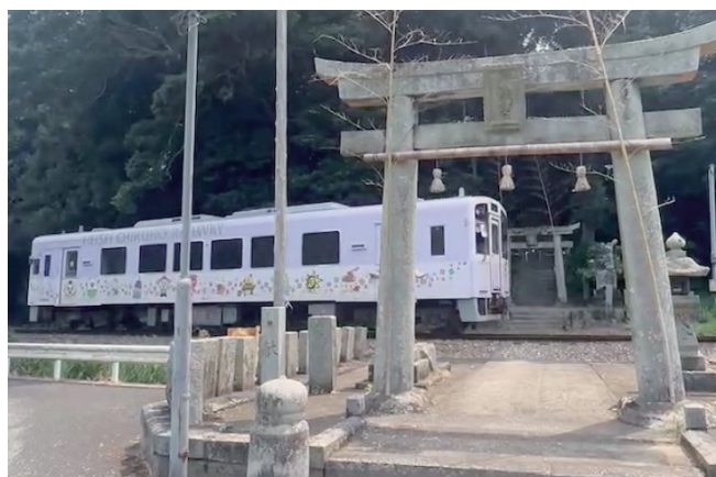
遮断機も警報機も設置されていない踏切「第4種踏切」が、福岡県内には77か所ある
